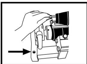
17. Stecken Sie die Stopfen wieder ein und ziehen die Schrauben (2) an, um den Volant zu fixieren.
