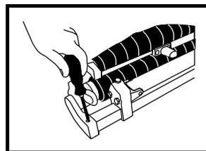
19. Bringen Sie schließlich die Markisenstange an und schrauben Sie die vorderen und hinteren Schrauben fest.
