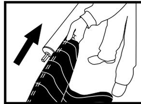
11. Wechseln Sie nun den Markisenstoff aus, indem Sie die Stoffrückseite entlang der Spur in die Rolle einschieben.
