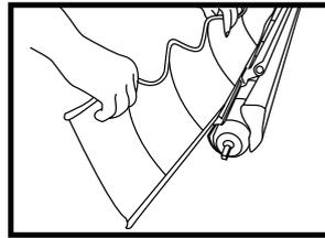
6. Entfernen Sie den Volant aus der Volantstange.
