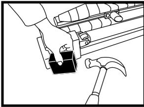
5. Nehmen Sie einen Holzklotz und schlagen Sie damit auf die Seite der Markisenstange. Dies wird die Endstange lösen, sodass Sie anschließend die Stange leicht herausziehen können.
