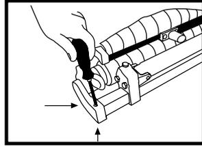
2. Entfernen Sie die zwei Schrauben, die sich sowohl vorne als auch hinten an der Markisenstange befinden. **HINWEIS:** Diese sind normalerweise mit einem Aufkleber verdeckt.
