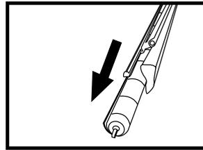
7. Schieben Sie die Stoffrolle aus dem Markisengehäuse heraus.
